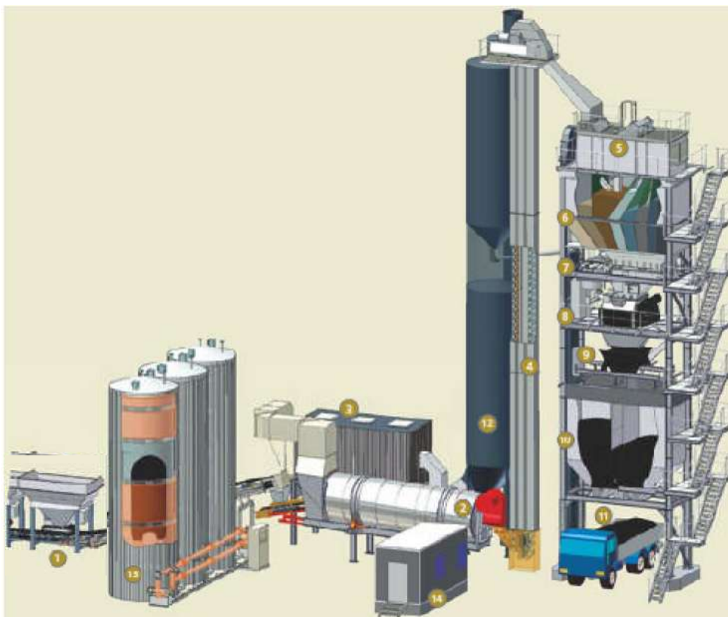
Figure 6 : Schéma d'une installation d'enrobage
