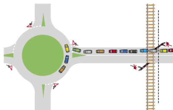
Figure 11: Remontée de file due à un giratoire
